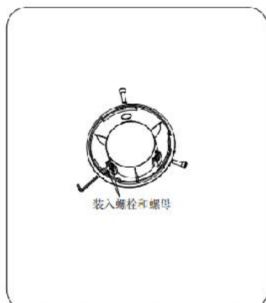
①. 接头上装入螺栓和螺母，螺栓不上紧
